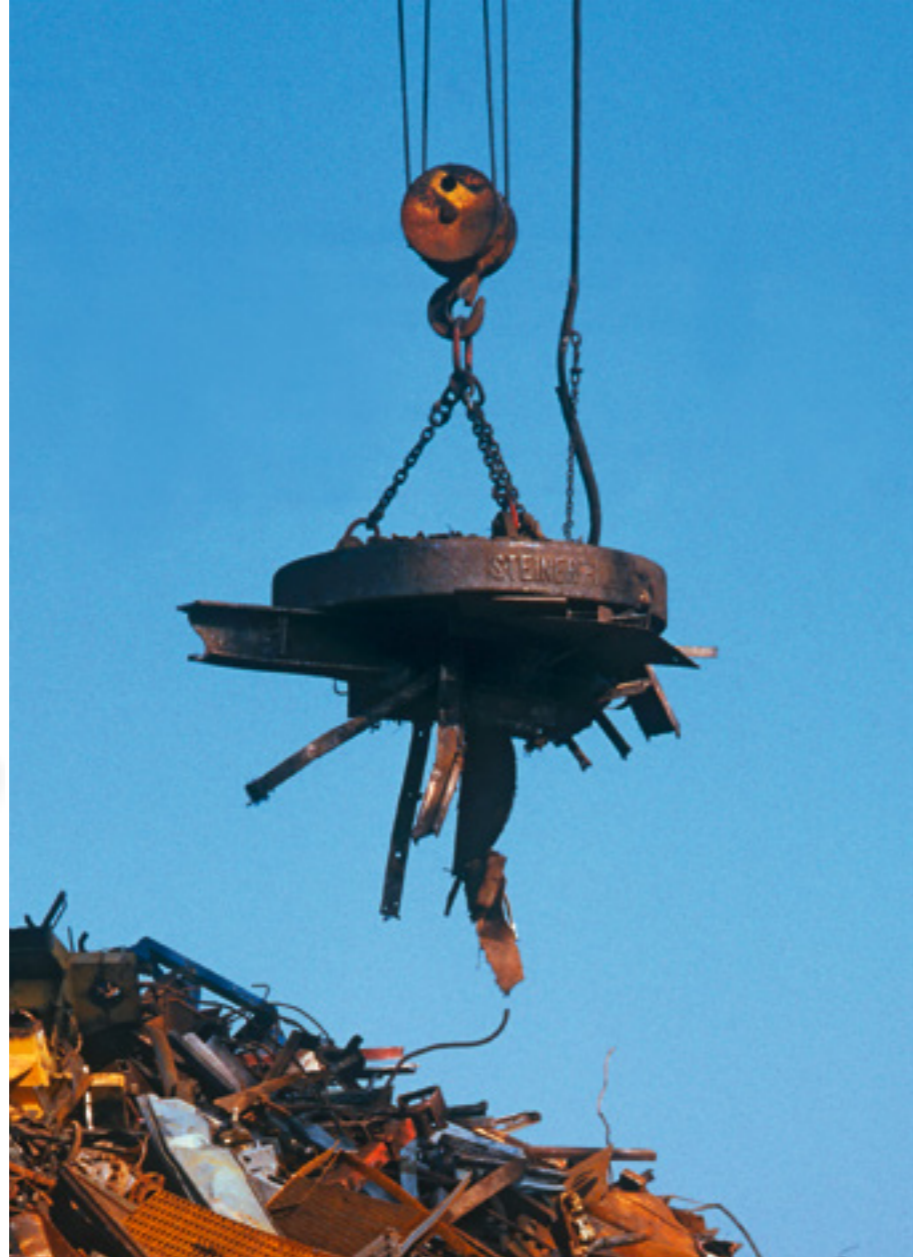
Kraftmaschine Auf dem Schrottplatz hilft ein Elektromagnet Alteisen sortieren. Aktiviert und deaktiviert wird die magnetische Scheibe durch Ein- und Ausschalten von Strom.
